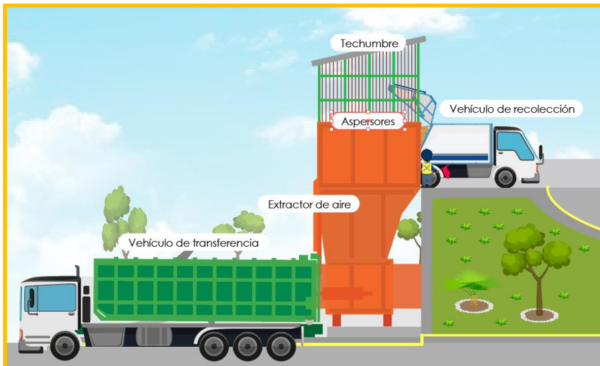
Imagen No. VI.3.4.2 Conceptualización de una Estación de Transferencia de Descarga Directa.
