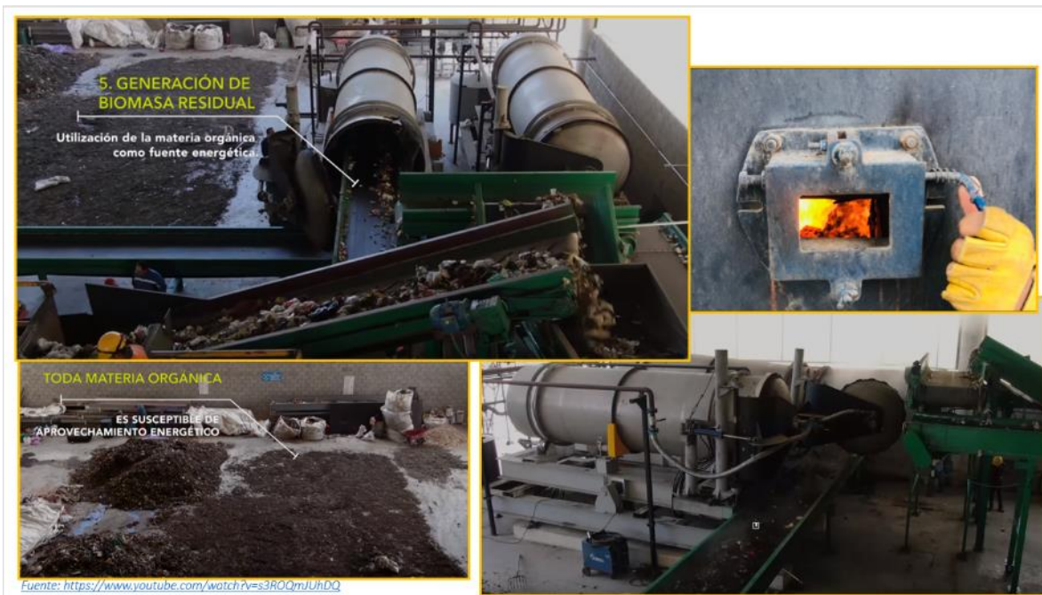
Imagen No. VI.3.6.3.5 Procesos de producción de la planta de biomasa residual
